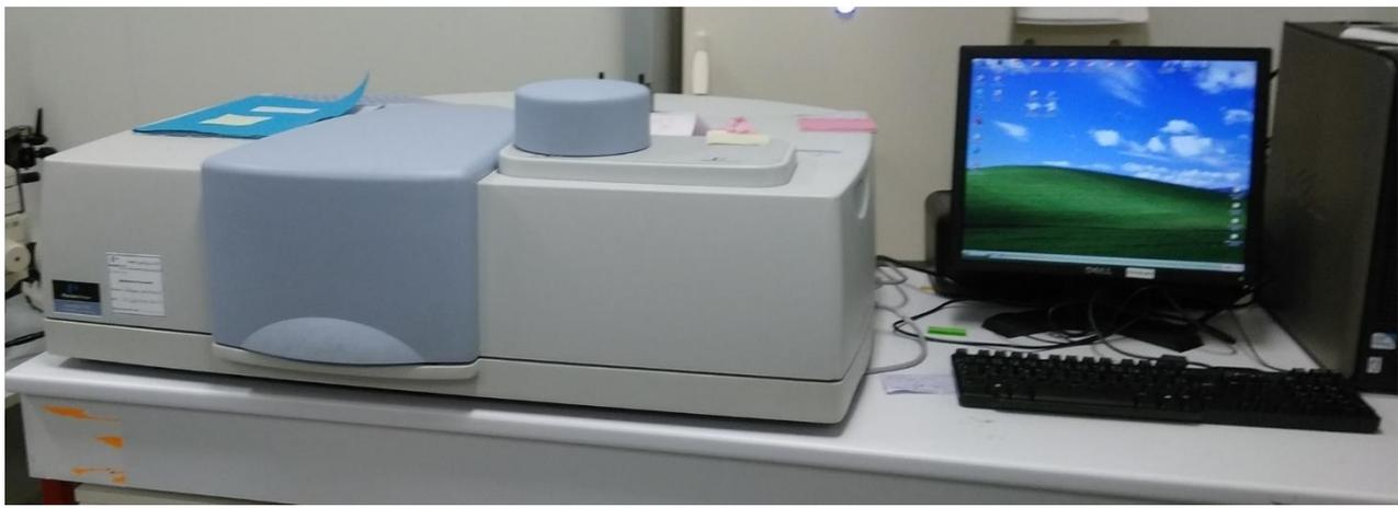
Spectrophotomètre Perkin-Elmer (Transmission / Réflexion / Sphère intégrante)
