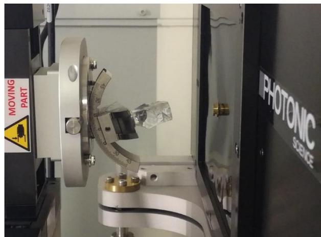
**Cristal de  $\text{LiYF}_4:\text{Tb}^{3+}$  en cours d'orientation au Laue**
