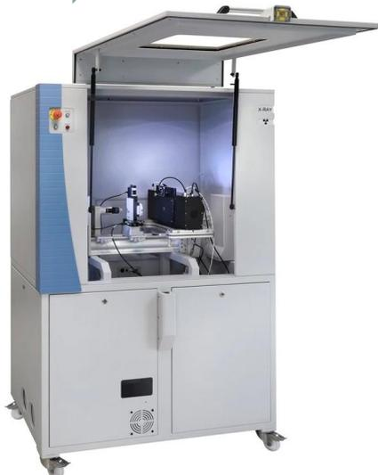
**Diffractomètre à Rayons X de type Laue en réflexion pour orienter les cristaux**
