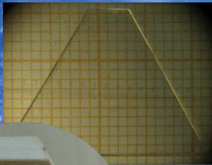
Lamelle [001] observée sous polariseurs
